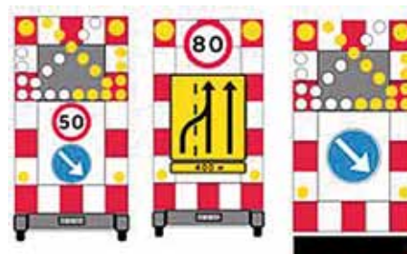
Figur 7. Eksempler på afmærkningsvogne – afspærringsvogn, tavlevogn og TMA.
